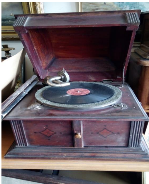
Сн. 3. Немски грамофон от началото на 20-те години на XX в. с вградена фуния – лична колекция на автора.
